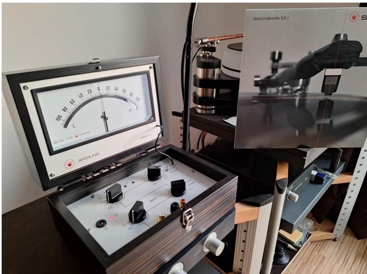
Grundvoraussetzung für eine optimale Stereoabtastung ist der korrekte Nadelazimut, d.h. dessen 90 Grad – Stellung zur Rillenoberfläche. Schon geringe Abweichungen führen zu Verschlechterungen der Kanaltrennung und letztlich auch zu Verzerrungen, vor allem der Räumlichkeit.
